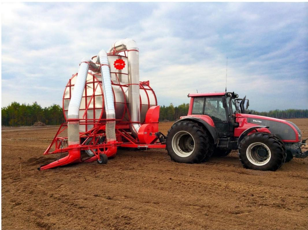
Рисунок 2.2 – Технология уборки фрезерного торфа вакуумным методом
