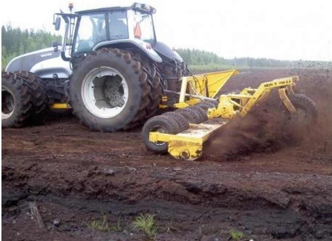
Рисунок 2.1 – Фрезерование торфа
